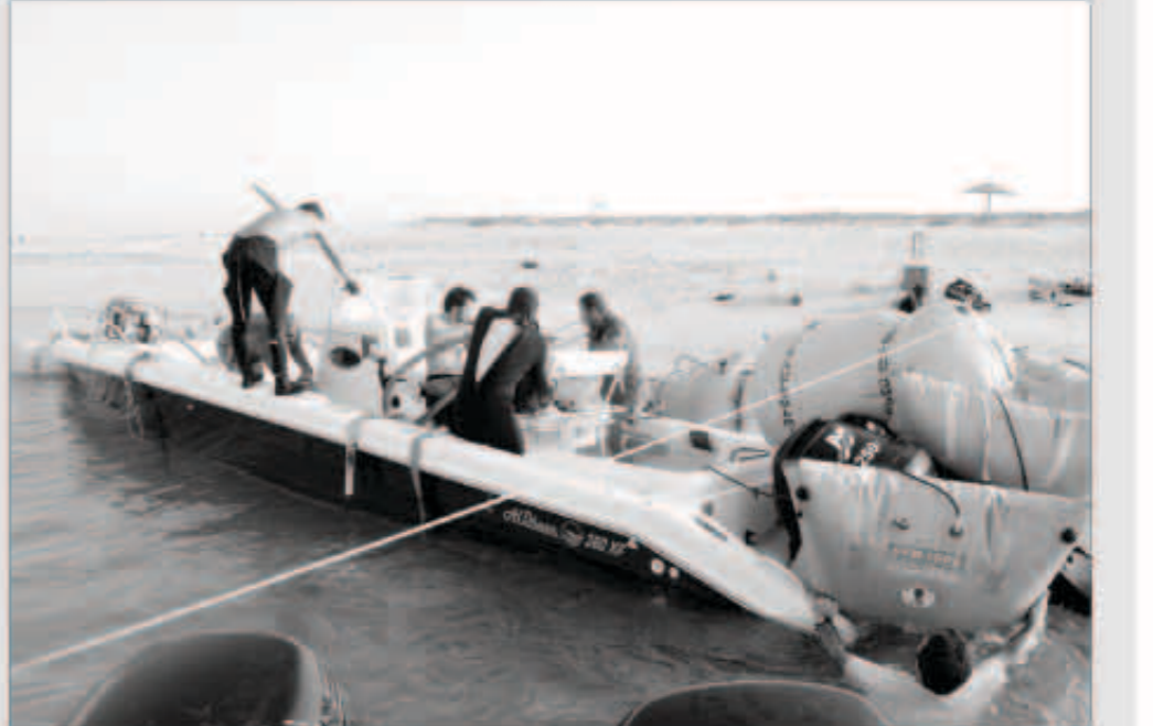
رفع القارب باستخدام الحفائظ الهوائية
