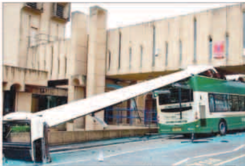
حافلة اقتلع سقفا بعد مرورها تحت جسر متخلف
