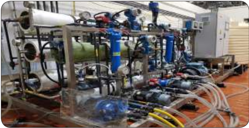
■ مشروع (تقييم كفاءة وجودة وحدتين نموذجيتين لتقنيات أغشية التناضح المباشر لتحلية المياه)
