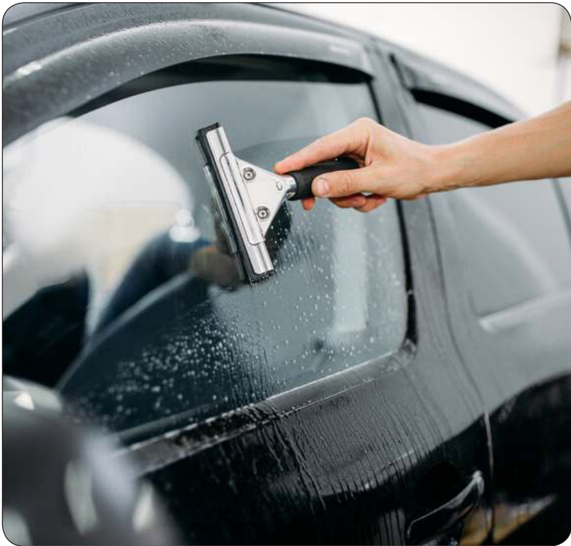
■ جانب من عملية تركيب التظليل الحراري
