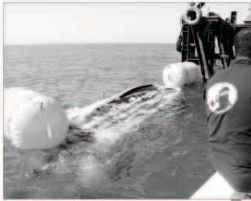
استخدام مضخات المياه والحفاب الهوائية في العملية
